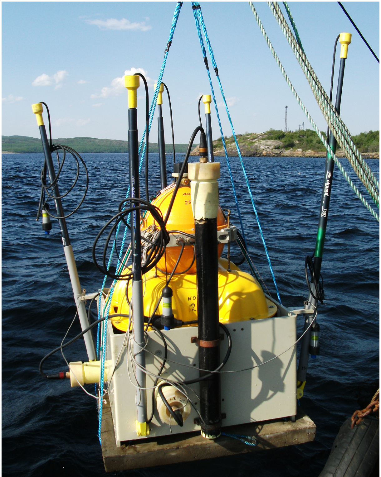
Рисунок 3.20 — Приемная аппаратура морского приемно-передающего комплекса перед погружением.
